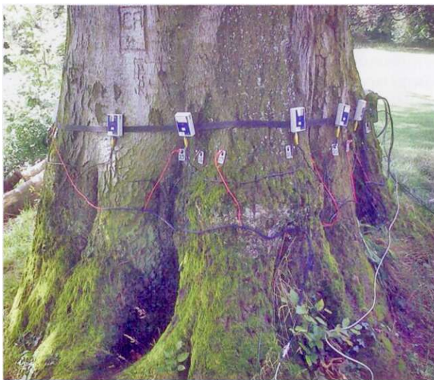
Oft lässt sich bei einer visuellen Beurteilung von aussen nicht einwandfrei feststellen, wie standsicher ein Baum ist. Diese Buche wird deshalb mittels Ultraschall untersucht.
